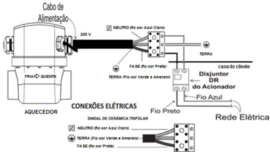
**!** O Fio Terra deverá ser sempre aterrado conforme norma NBR 5410. Nunca instale o Aquecedor sem ligar o Fio Terra. A NBR 5410 (Instalações Elétricas de Baixa Tensão) determina a instalação de um disjuntor DR exclusivo para o circuito do aquecedor digital, com corrente diferencial de 30mA e corrente nominal conforme consumo do circuito.
