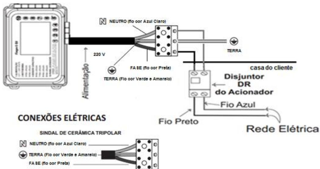
O Fio terra deverá ser sempre aterrado conforme norma NBR 5410. Nunca instale o acionador sem ligar o Fio Terra. (Ver item 6.1.6 – aterramento)
