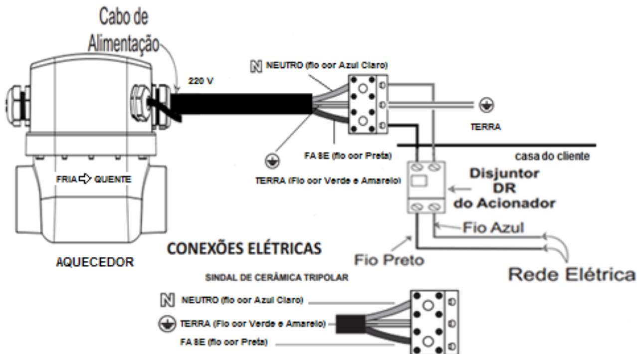
**!** O Fio Terra deverá ser sempre aterrado conforme norma NBR 5410. Nunca instale o Aquecedor sem ligar o Fio Terra. A NBR 5410 (Instalações Elétricas de Baixa Tensão) determina a instalação de um disjuntor DR exclusivo para o circuito do aquecedor digital, com corrente diferencial de 30mA e corrente nominal conforme consumo do circuito.
